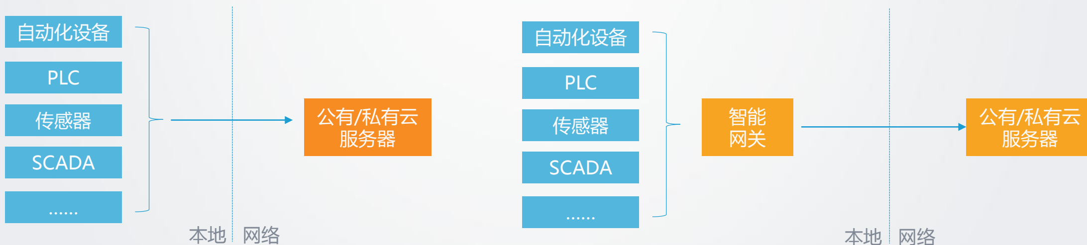
亿欧智库：工业数据采集分析的云计算架构和边缘计算架构示意
